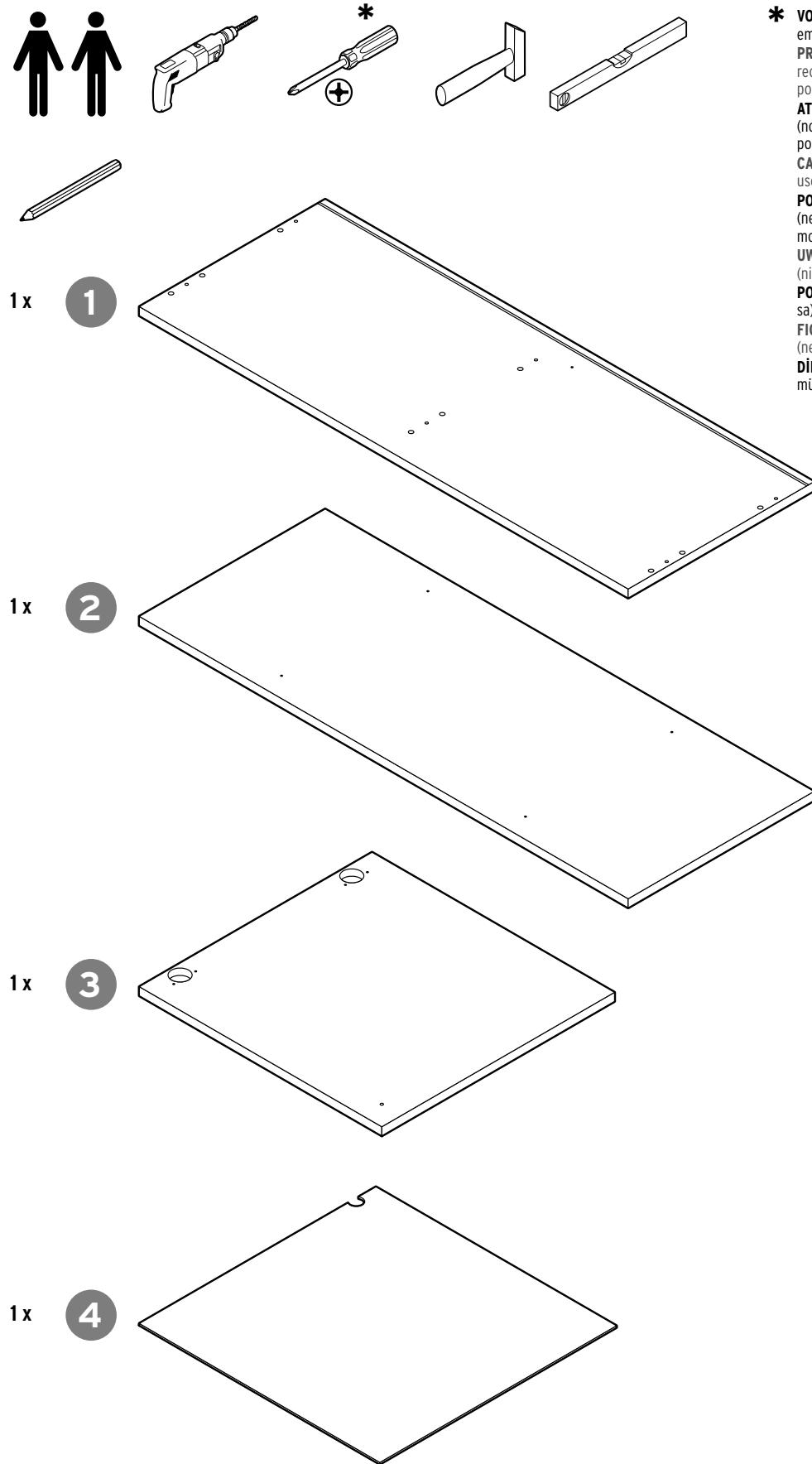
\* **VORSICHT:** Bei Verwendung eines Akkuschraubers (nicht empfohlen) möglichst niedrige Drehmomentstufe wählen!
